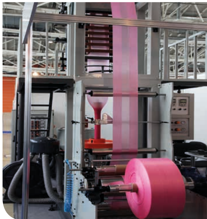
Einsatz von temperaturbeständigen Schläuchen zum Absaugen heißer Luft bei der Blasfolienherstellung
