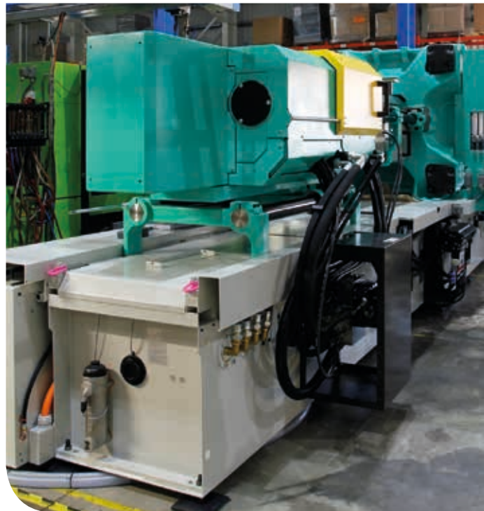
Einsatz von Heizschläuchen bei der Spritzgussherstellung. Der flüssige Kunststoff muss konstant auf einer Temperatur gehalten werden
